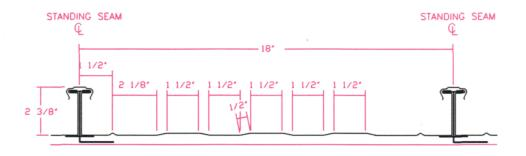
1 TYPICAL R-MER SPAN-18 SYSTEM APPLICATION N.T.S.
